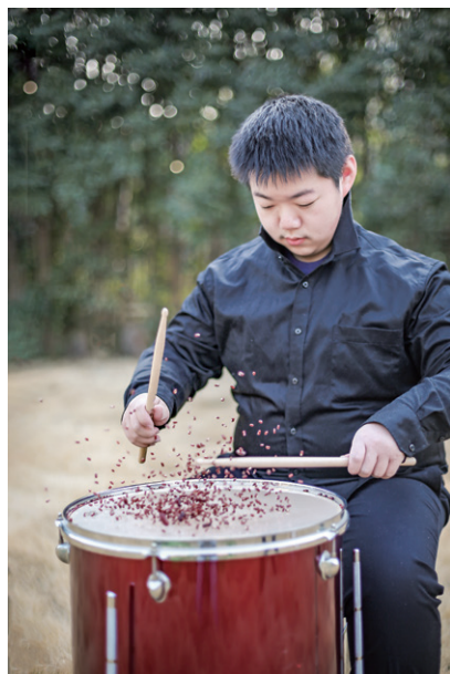
图 1-13 探究鼓声强弱与鼓面振动幅度的关系
