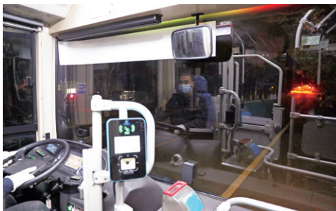
图 2-28 车内的人或物通过风挡玻璃成像会干扰驾驶员视线
