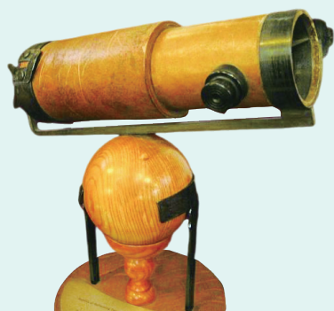
图 3-34 牛顿制造的反射式望远镜
