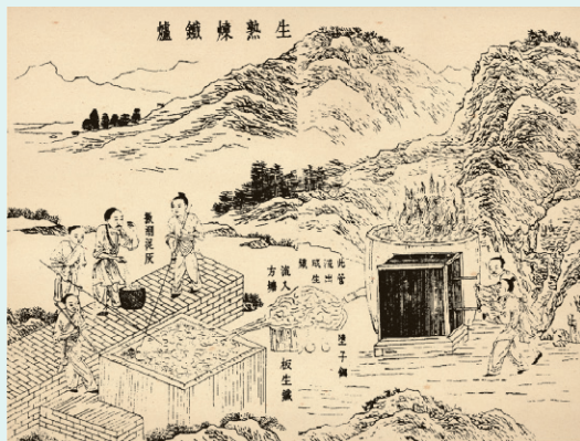
图 4-30 灌钢法（《天工开物》）
