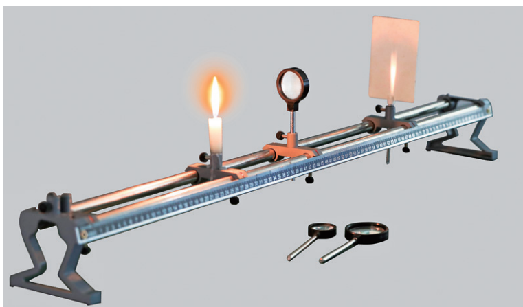
图 3-23 探究凸透镜成像的规律
