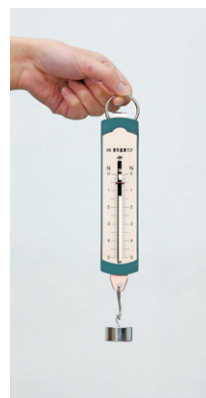
图 7-9 测量物体所受的重力
