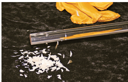
图 10-12 带电有机玻璃棒能吸引纸屑
