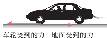
图3.3-5 汽车受驱动力的示意图
