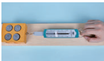
图3.2-4 测量静摩擦力的实验装置
