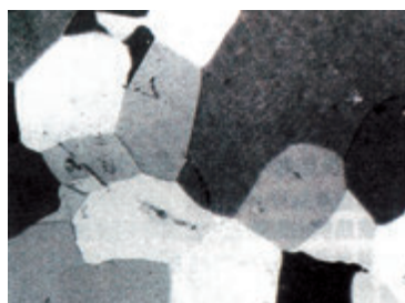
图2.4-7 金相显微镜下的铝—锂—锰合金
