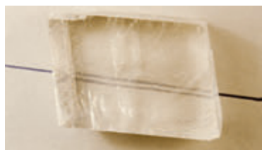
图 2.4-6 方解石的双折射现象
