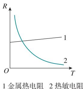
图 5.2-4 电阻随温度的变化关系
