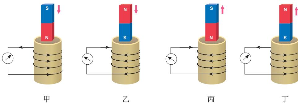
图2.1-1 研究感应电流方向的实验记录
