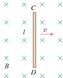
图 2.2-4 导体棒做切割磁感线运动
