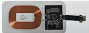
图3.3-5 无线充电接收器中的线圈
