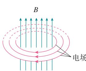
图4.2-1 变化的磁场产生电场
