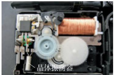
图4.1-4 石英电子钟里的晶体振荡器
