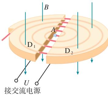
图 1.4-3 回旋加速器的原理
