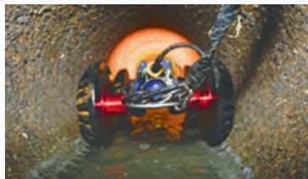
甲 机器人在下水道里探测水管网
