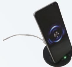
图3.3-4 对移动电话进行无线充电
