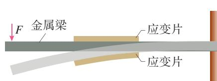
图5.2-8 应变片测力原理
