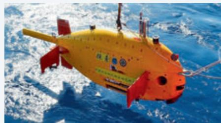
丙 我国自主研发的探索号自治式水下机器人
