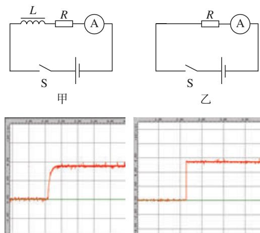
图2.4-4 显示通电时线圈对电流影响的实验
