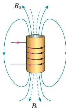
图 2.4-2 感应电动势阻碍电流的增加
