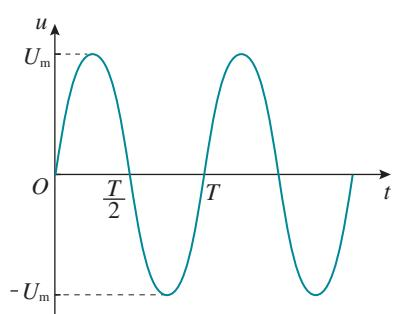
图3.2-3 正弦式交变电流 $u-t$ 图像
