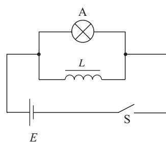
图 2.4-3 开关断开时观察灯泡的亮度
