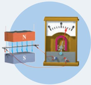
在用导线切割磁感线产生感应电流的实验中，导线切割磁感线的速度越快、磁体的磁场越强，产生的感应电流就越大。在向线圈中插入条形磁体的实验中，磁体的磁场越强、插入的速度越快，产生的感应电流就越大。这些现象向我们提示，当回路中的电阻一定时，感应电流的大小可能与磁通量变化的快慢有关，而磁通量变化的快慢可以用磁通量的变化率表示。也就是说，感应电流的大小与磁通量的变化率有关。
