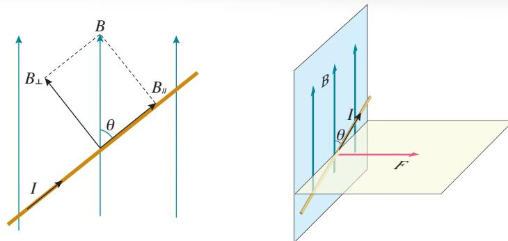
图 1.1-4  $B$  与电流方向的关系
