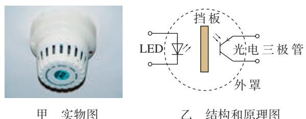
图5-4 烟雾散射式火灾报警器
