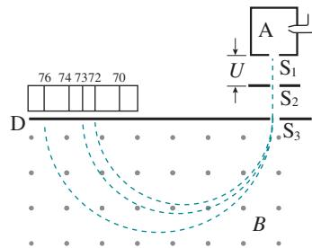
图 1.4-1 质谱仪工作原理
