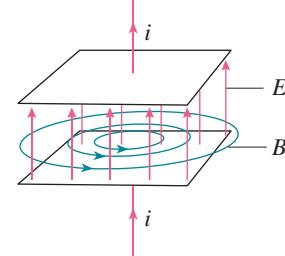
图4.2-2 变化的电场产生磁场
