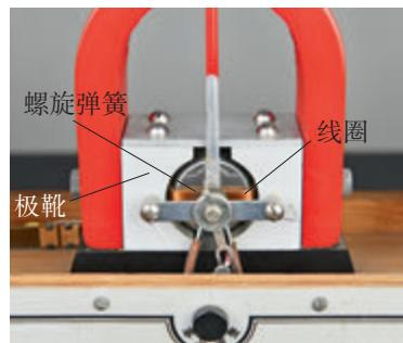
图 1.1-6 磁电式电流表的结构
