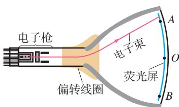
图 1.2-7 显像管原理示意图
