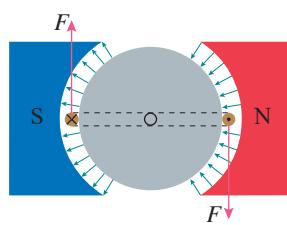
图 1.1-8 极靴和铁质圆柱使磁场沿半径方向
