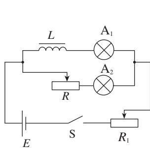
图 2.4-1 开关闭合时观察灯泡的发光情况
