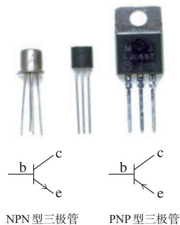
图5.3-4 三极管电路符号及实物图
