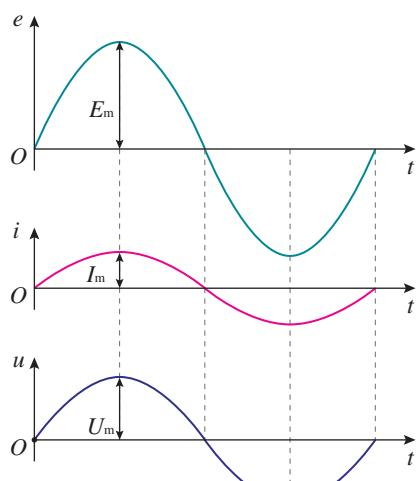
图 3.1-6 正弦式交变电流随时间的变化
