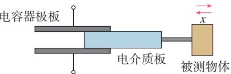
图 5.2-10 电容式位移传感器
