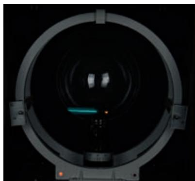
图1.3-3 没有磁场时电子束沿直线运动
