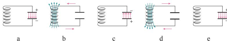
乙 振荡电路电流的周期性变化
