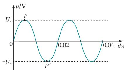
图3.2-1 交变电流的 $u-t$ 图像
