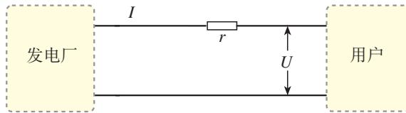
图 3.4-2 输电电路图
