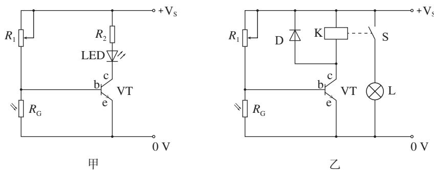
图5.3-5 光控开关电路
